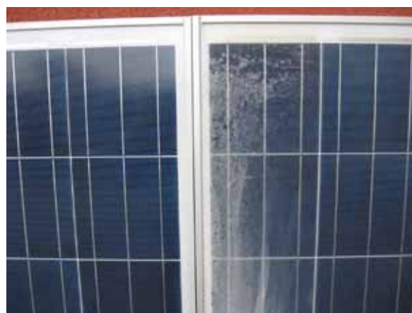
Bild 5: Schadenbild rechts nach dem DLG-Ammoniaktest (Quelle VDE / DLG)
